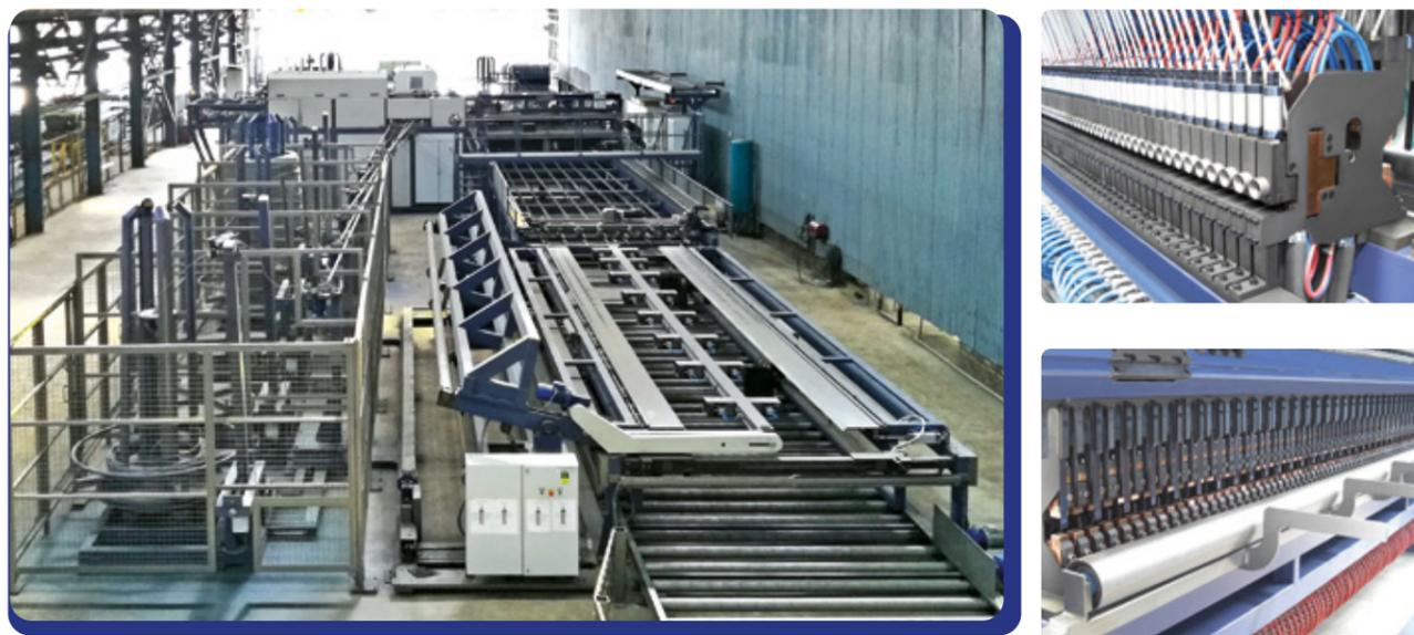
Voll ausgestattet mit Schweißköpfen über die ganze Schweißbreite und Doppeldrahtzufuhr für Längs- und Querdrahte sorgt die AMM II in Synergie mit den Rotorrichtmaschinen der Flexi-Line Twin-Serie, für höchste Produktivität, die herkömmliche Mattenschweißlinien übertrifft.
