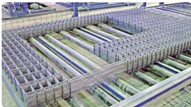
Die AMM I nutzt die fortschrittliche Richttechnologie von EUROBEND mit hyperbolischen Richtrollen der fünften Generation mit wartungsfreien Rotoren und unterstützt bis zu sechs Durchmessern. Dies bietet eine unübertroffene Flexibilität bei der Mattenproduktion.
