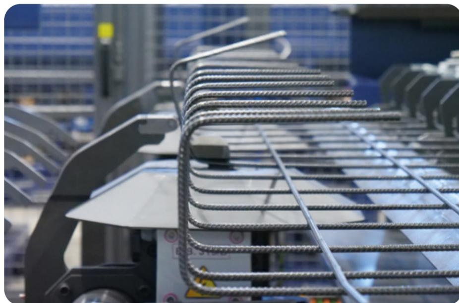
Durch die Kombination ausgefeilter Technik, Servo-Technologie und fortschrittlicher Software setzt dieses System neue Maßstäbe für technische Spitzenleistung in der Branche. Mit beispielloser Präzision führt es zwei Biegungen in nur 2,5 Sekunden aus und gewährleistet eine gleichbleibend genaue Biegegeometrie.
