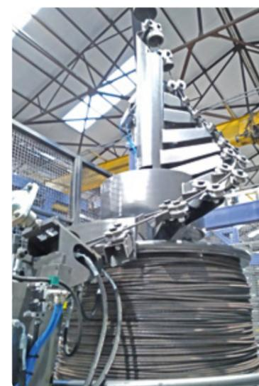
Dévidoir vertical breveté pour les fils jusqu'à 12mm et bobines de 6T
