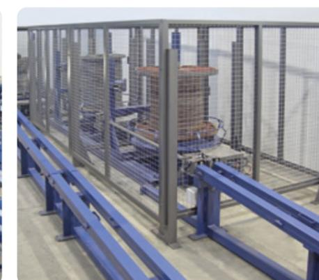
Dévidoirs verticaux pour bobines jusqu'à 3T
