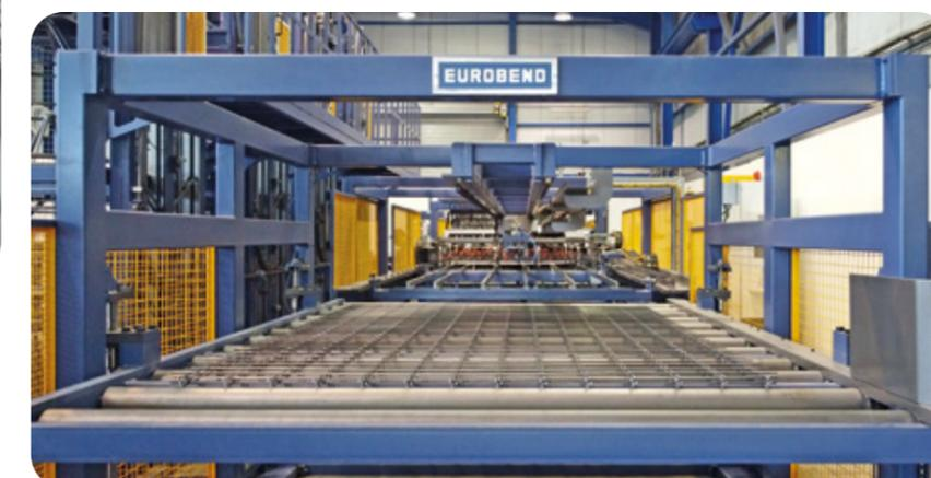
Convoyeur à rouleaux avec ajustement de la hauteur
