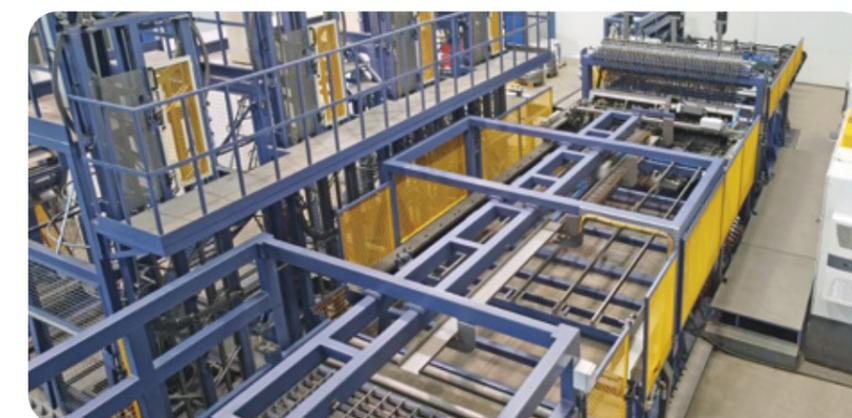
Dispositif robotisé d'empilage
