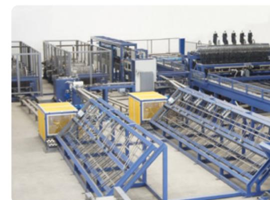
Dévidoirs horizontaux pour les bobineaux jusqu'à 3T avec poumon
