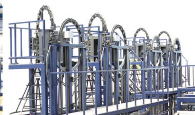
Dévidoirs statiques verticaux avec poumon intégré pour les fils jusqu'à 8mm et bobines de 3T
