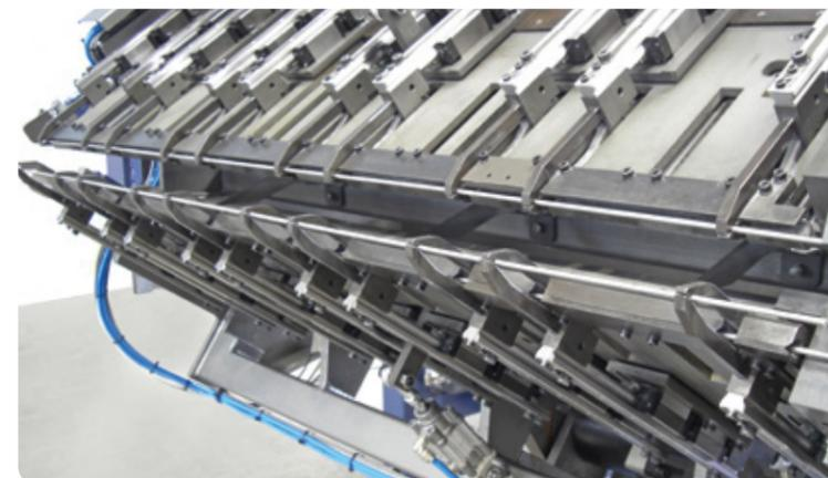
Alimentation des fils de trame au-dessus et au-dessous
