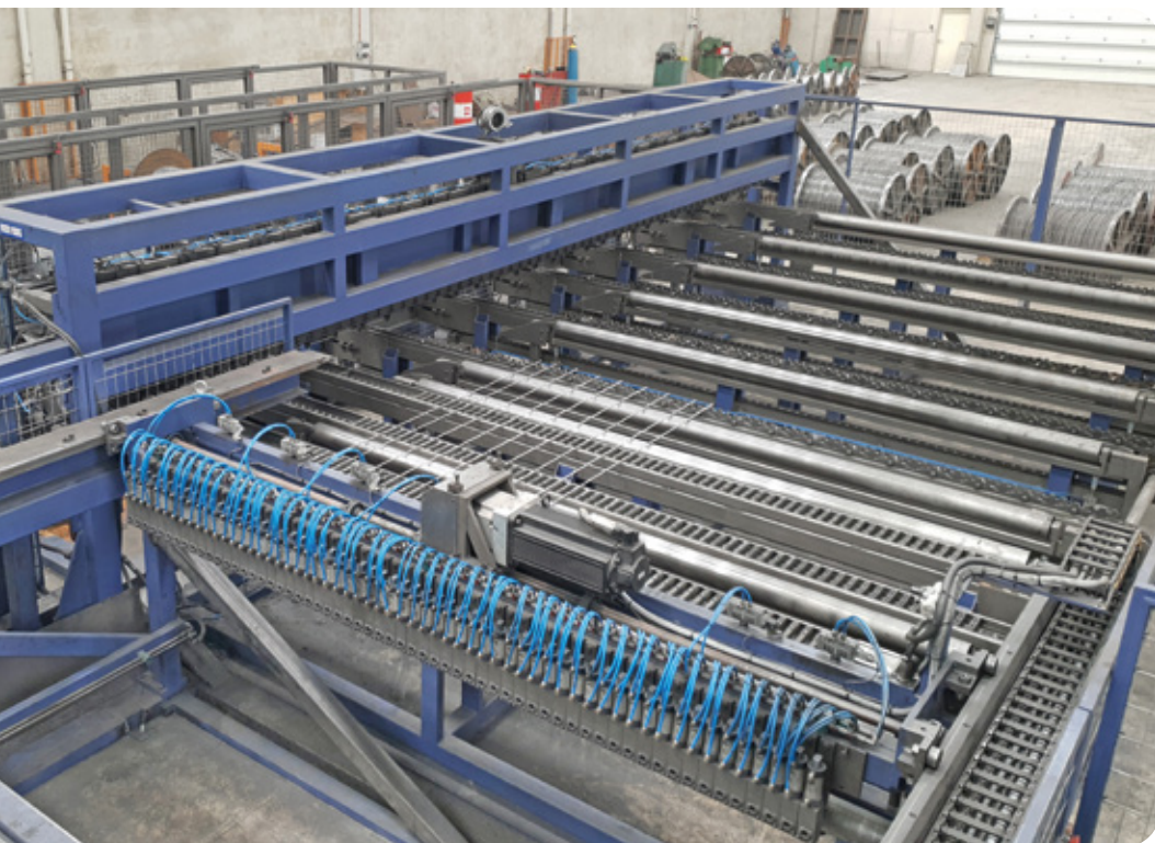
Carregador Alimentador dos Arames Longitudinais
