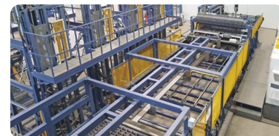
Unidade de Empilhamento Robótica
