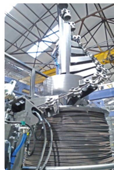
Estação de desbobinamento tipo Overhead PATENTE para bobinas de até 6T e 12mm
