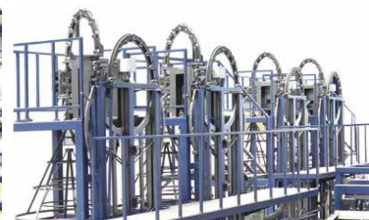
Stazioni svolgitori sopraelevati con anello incorporato per bobine fino a 12mm 6Ton.
