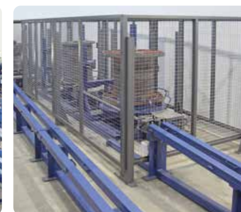
Stazioni con aspi svolgitori per bobine verticali fino a 3Ton
