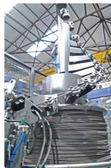
Stazione svolgitore sopraelevato BREVETTATO per bobine fino a 12mm 6Ton
