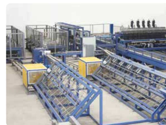
Stazioni con aspi svolgitori per bobine orizzontale fino a 3Ton con anello accumulatore
