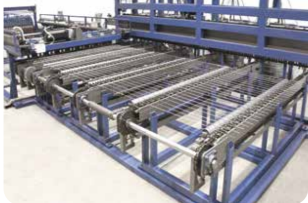
Piano di alimentazione del filo di linea
