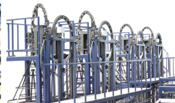
Haspelstation mit vertikalem Ablauf für bis zu 8mm 3T Coils, mit integriertem Puffersystem
