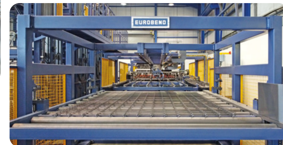
Rollenförderer für die fertigen Matten mit Höheneinstellung
